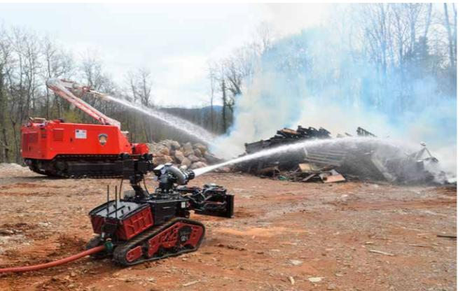
Demonstracija tehničkih mogućnosti robota, specijaliziranih za gašenje požara
